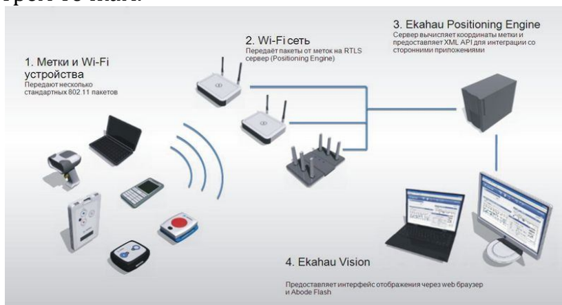
Рис.2. Система позиционирования в помещении фирмы EkaHau
