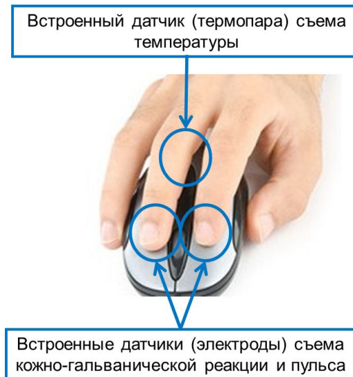
Рис. 2. Модификация манипулятора мышь для использования совместно с системой дистанционного обучения
